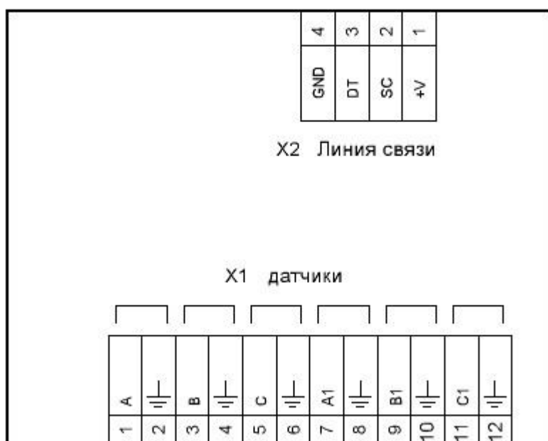
Схема подключения коммутатора СКВН2
